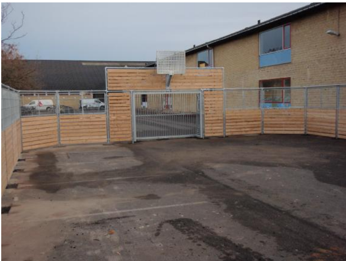
Sofiendalsskolen, Haslev. Levering og montering af multibane på eksisterende asfaltbelægning i skolegård. Banen måler 11,6 x 24.6 meter, og monteres med tråd gitter over banderne for bold fang. Over målene er monteret basketkurve.
